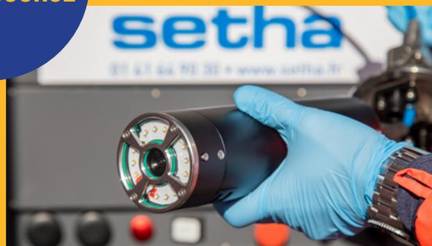
En complément de **CANASCAN**®, outil de gestion patrimoniale by **SETHA**, **SETHA** se dote d'une nouvelle technologie, **Inspect'O**®, pour rechercher les fuites, inspecter et diagnostiquer sans coupure d'eau les canalisations d'eau potable (à partir du Ø 200 mm) dans le respect du protocole de sécurité sanitaire de l'eau.
